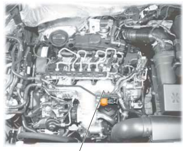
Переключающий клапан радиатора системы рециркуляции отработавших газов N345
