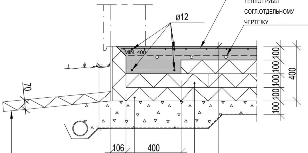
100 мм БЕТОННАЯ ПЛИТА 3x100
