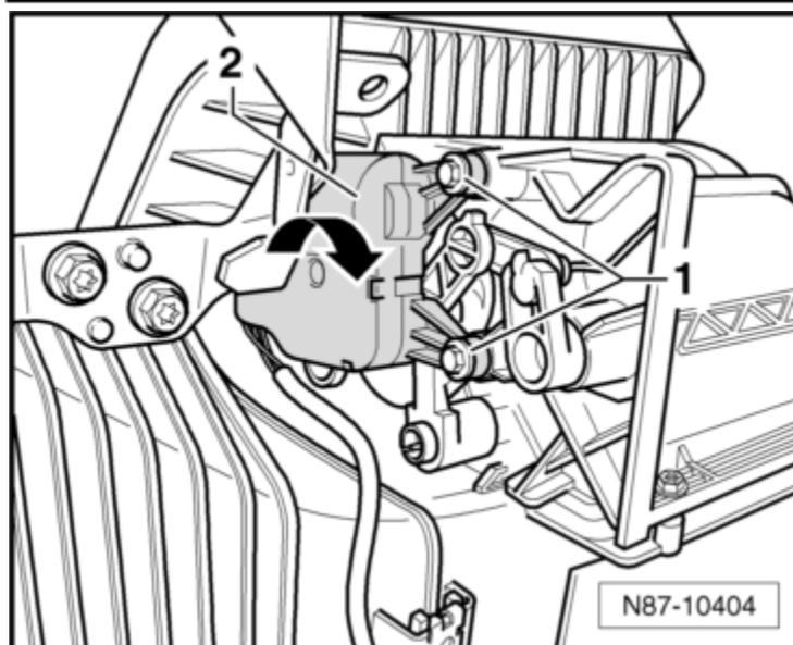
– Серводвигатель подходит к изогнутой шайбе только в одном положении.
