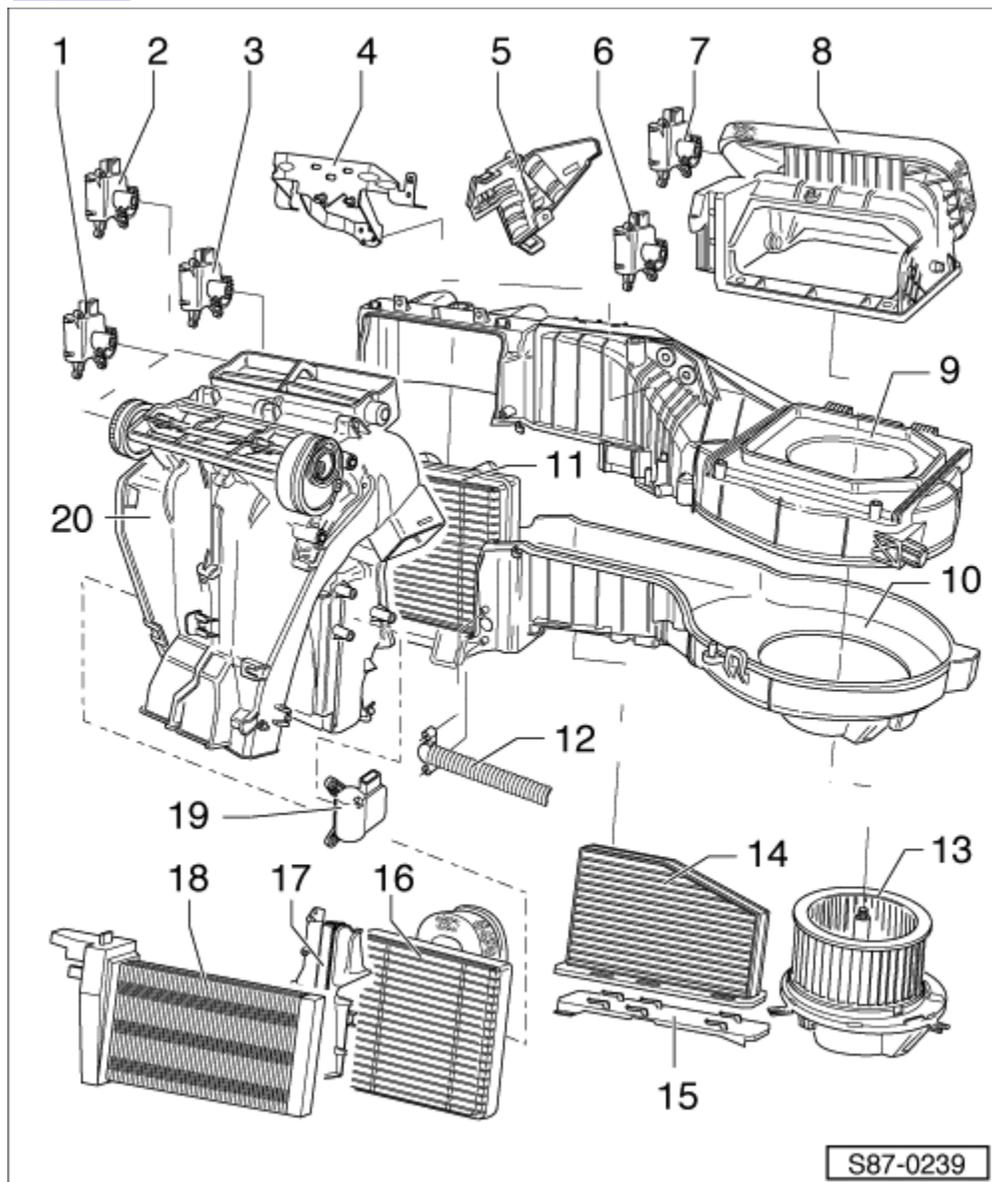
1 - Серводвигатель центральной заслонки -V70-
