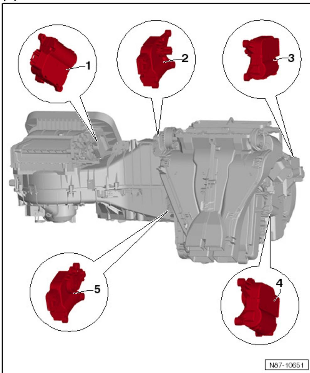
1 - Серводвигатель заслонки скоростного напора и заслонки рециркуляции воздуха -V71-
