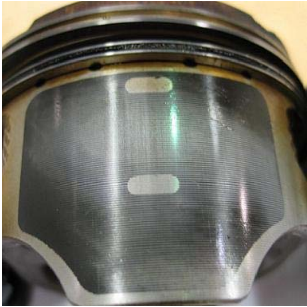
Е1: поршень со следами нормальной работы
