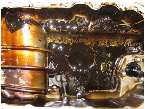
A3: состояние масла: с осадком, вязкое
