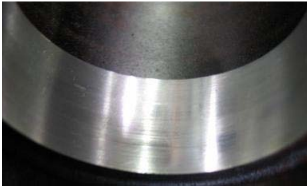
C1: следы нормальной работы с минимальными бороздками
