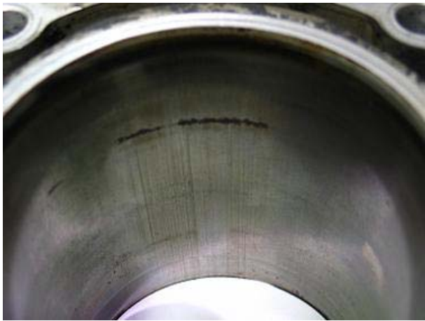
D3a: глубоких борозд практически нет – ещё различима структура после хонингования
