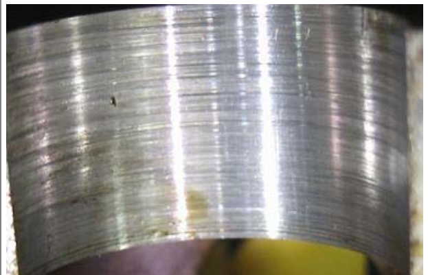
C4: много глубоких, отчётливо выраженных борозд с переносом материала
