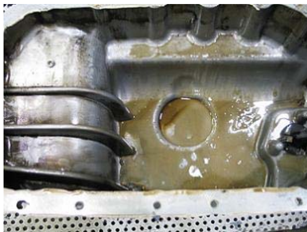
A4: масло с повышенным содержанием воды
