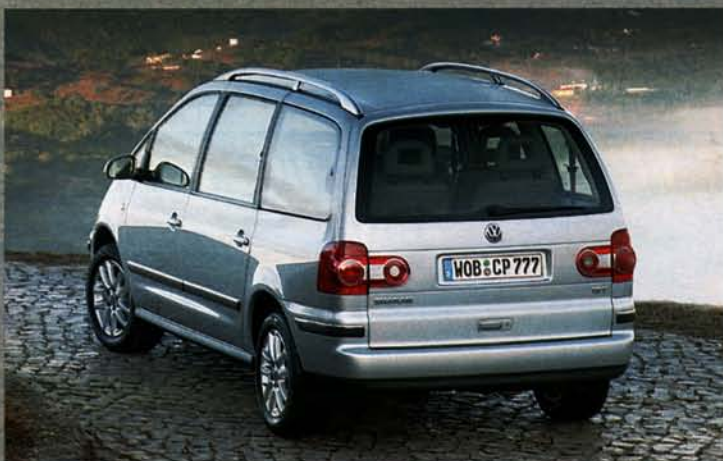
После второй модернизации в 2004-м изменились фонари. А также молдинг по периметру кузова получил хромированные вставки
